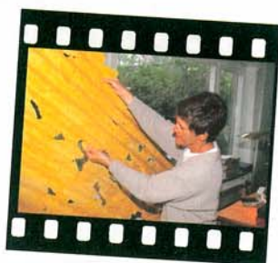
... oder auch so: Das Material wird auf eine spezielle Form aufgebracht und behält nach der Aushärtung seine Wellenstruktur
